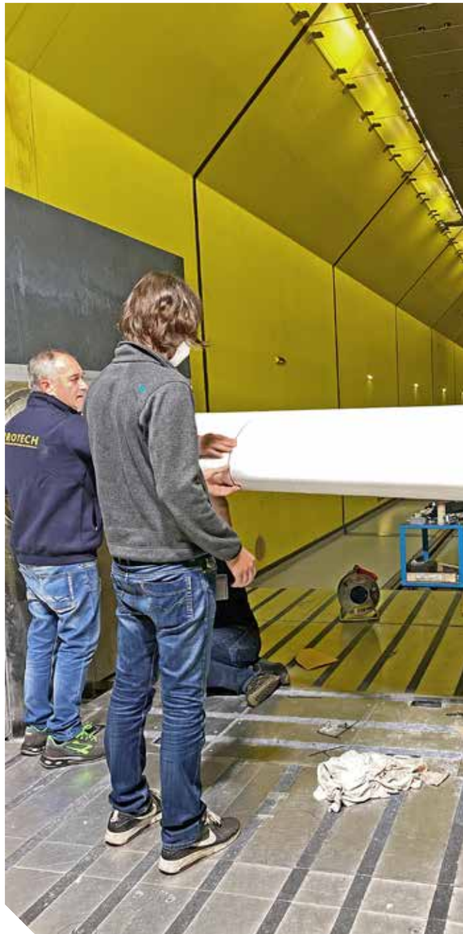
Expert:innen des AIT führen im Klima-Wind-Kanal Vereisungsversuche durch, die mit Simulationen und KI-Modellen verknüpft werden.
