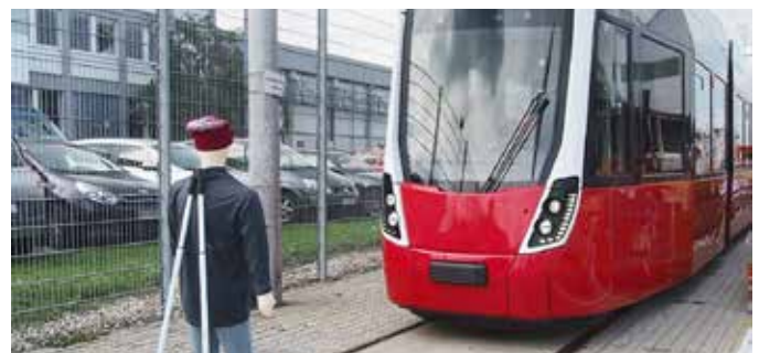
Das System erkennt Hindernisse, bewertet das Kollisionsrisiko in Echtzeit und warnt die Fahrer:innen vor potenziellen Gefahren.
