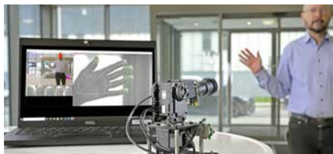
In Labors des AIT arbeitet man an innovativen Verfahren zur kontaktlosen Registrierung biometrischer Merkmale, wie etwa von Fingerabdrücken.
