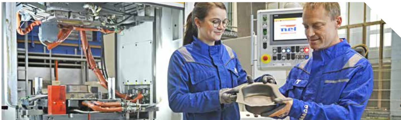
Die Expert:innen am LKR Leichtmetallkompetenzzentrum Ranshofen realisieren ein innovatives Verfahren zum Tiefziehen von Titanblechen.
